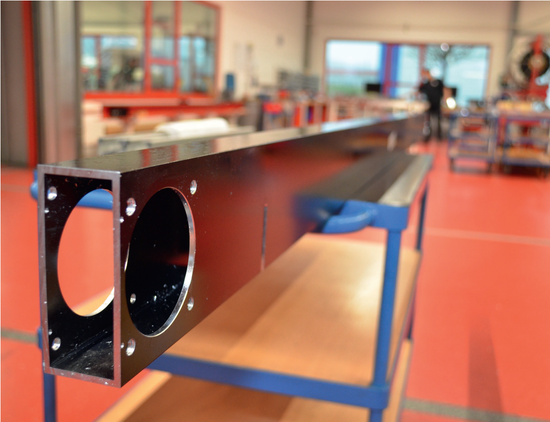
1 Saubere Sache: Die Fähigkeit, Aluminium trocken zu fräsen, hat bei Bahr Modultechnik die gesamte Profilmontage rationalisiert (© Hanser)
