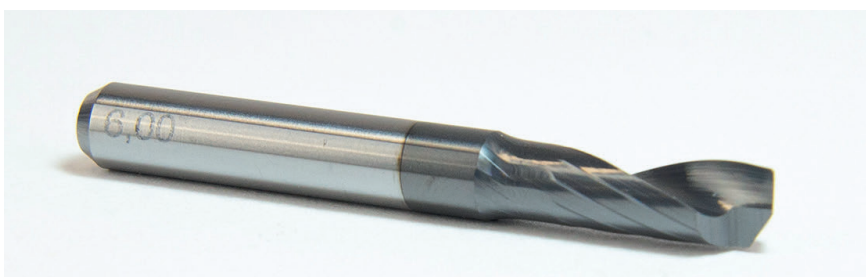
3 Kleine Nuten fräst Bahr trocken mit diesem Einschneider AL-1E, bei dem die große Spankammer das Zentrum bildet und die Späneabfuhr erleichtert. Die Beschichtung KMD401 trägt ihren Teil dazu bei, dass auf KSS verzichtet werden kann © ZCC-CT
