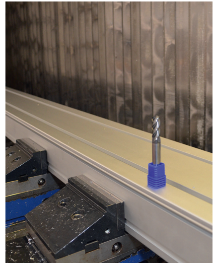
4 Der ebenfalls KMD401-beschichtete Dreischneider ALG-3E von ZCC-CT, hier auf dem Mazak-Zentrum mit 6 m Bearbeitungslänge, ist bei Bahr von 6 bis 12 mm Durchmesser in Gebrauch © Hanser
